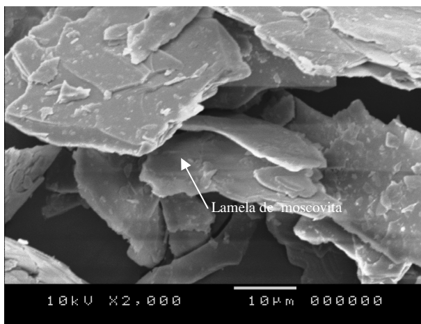
Figura 06: Detalhe das finíssimas lamelas de moscovita em fotomicrografia de MEV.
